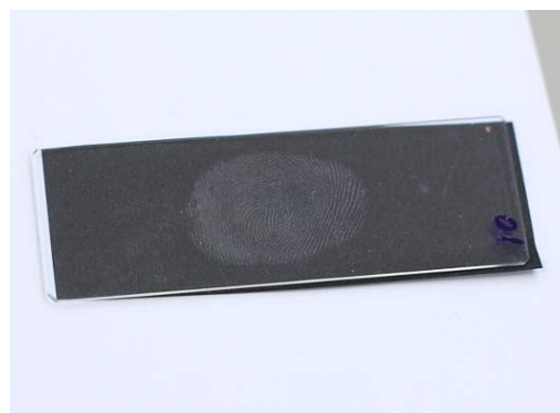
Рис. 4. Внешний вид образца исследования с нанесенным потожировым отпечатком пальца со следами ВВ
