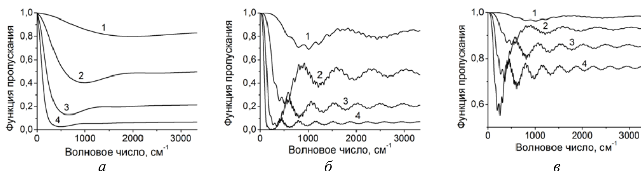
Рис. 1. Спектральная зависимость функции пропускания при h=10 м, \chi=0.1 : 1– R=5 мкм; 2– R=10 мкм; 3– R=15 мкм; 4– R=20 мкм. (а) – n=1.31 , N=10^5 л ^{-1} ; (б) – n=1.7 , N=10^5 л ^{-1} ; (в) – n=1.7 , N=10^4 л ^{-1}
